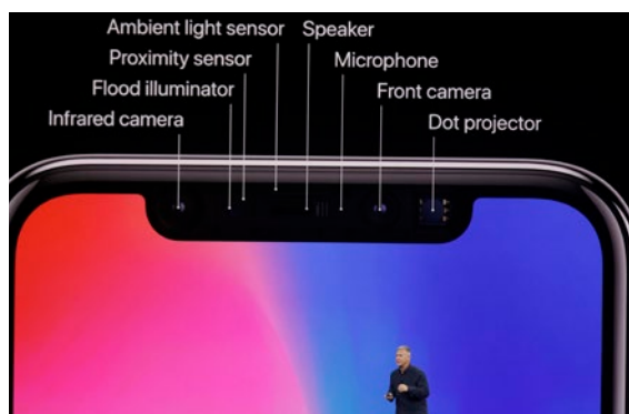
Figure 3 : Capteurs présents sur un iPhone Apple 13
