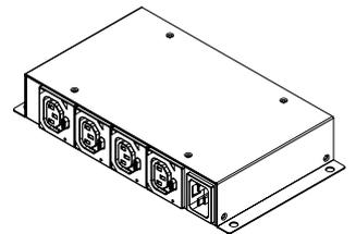
選項包括 NEMA 埠 (120V) 或 IEC 埠 (220-240V)，使單個 PDU 平台能夠在國內以及國際的應用中標準化。通用的 C20 輸入埠可通過任何行業標準的 AC 電源線靈活部署。
